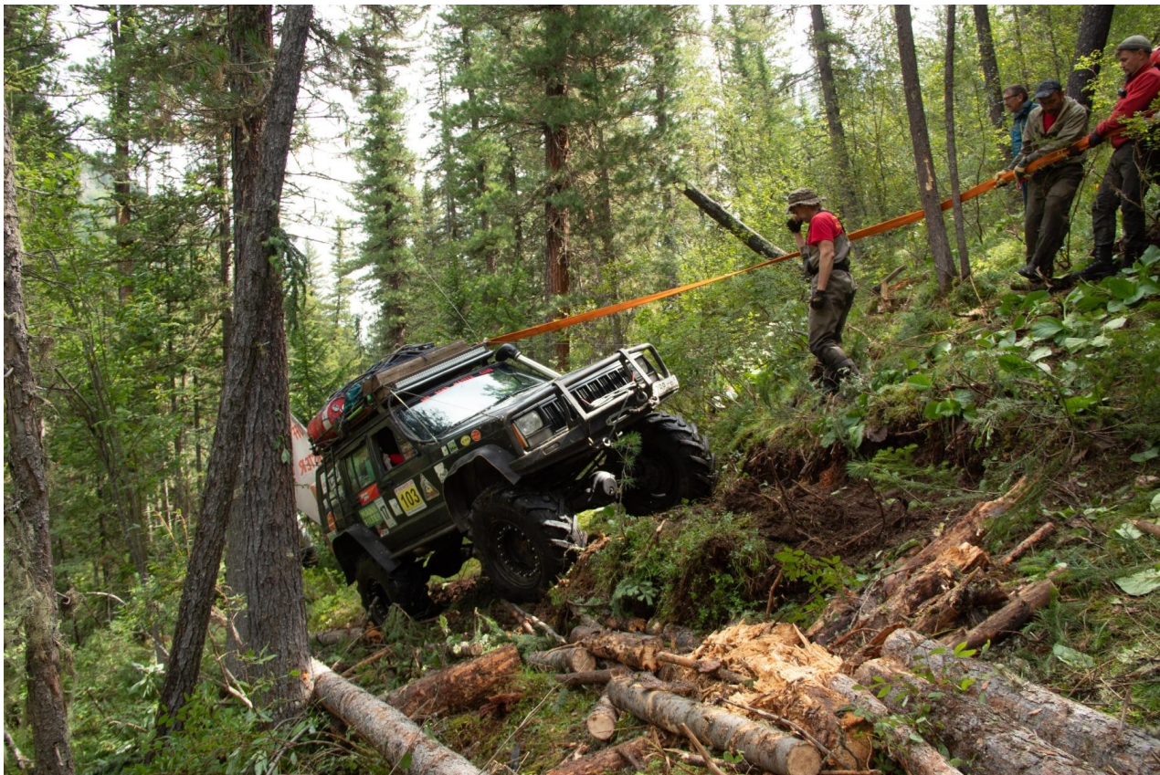
Фото 78. Прохождение прижима реки. Использование стропы для оттяжки на критичном крене.
