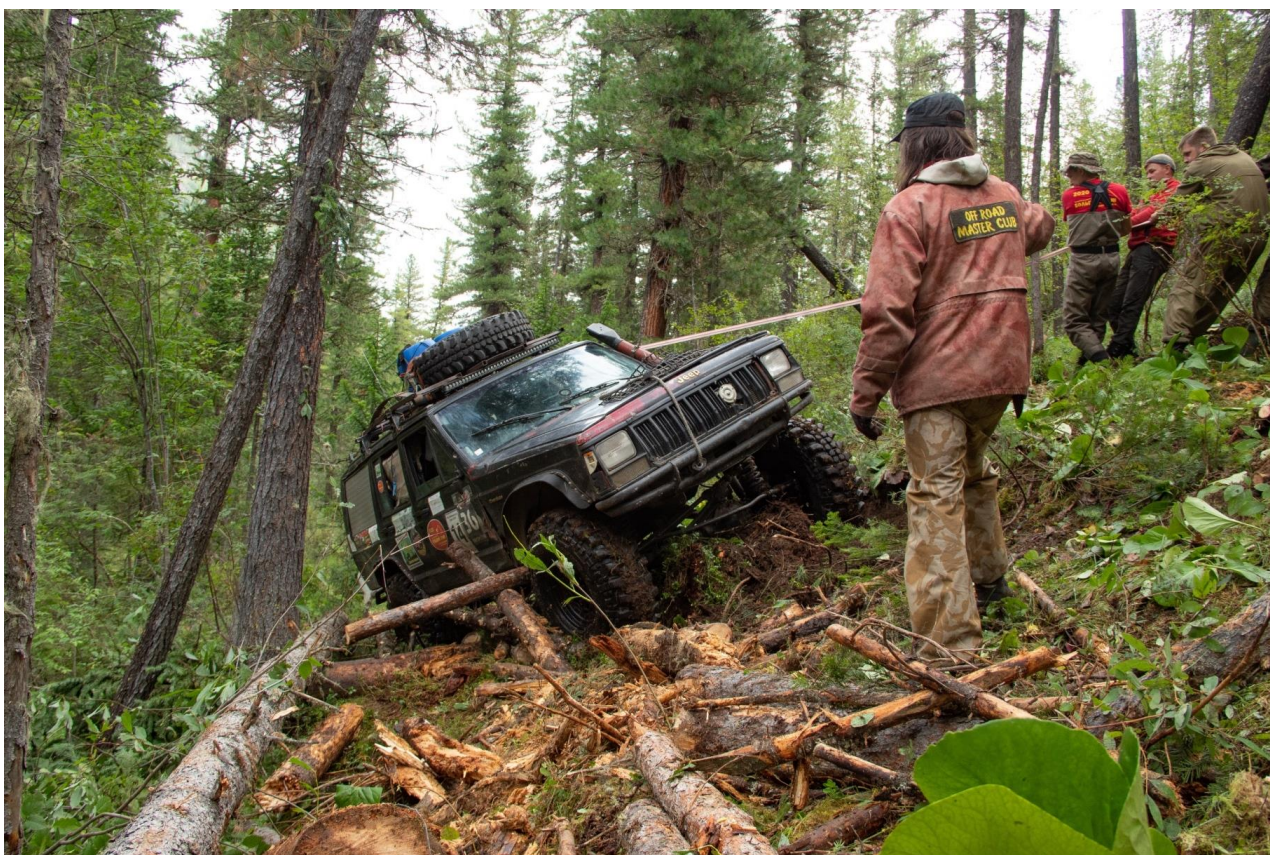
Фото 79. Прохождение прижима реки. Использование стропы для оттяжки на критичном крене.
